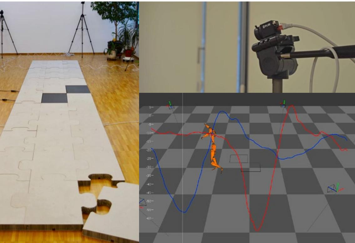
**Le laboratoire mobile et ses plaques de mesure de force, qui répartissent le poids d'une personne en forces tridimensionnelles et les quantifient.**
